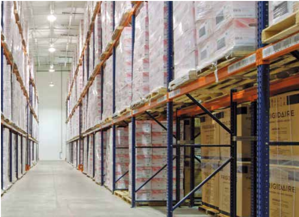
Arriba, almacén de paletización de 4 niveles de carga. Tarima manipulada por el lado de 1219.2 mm.
