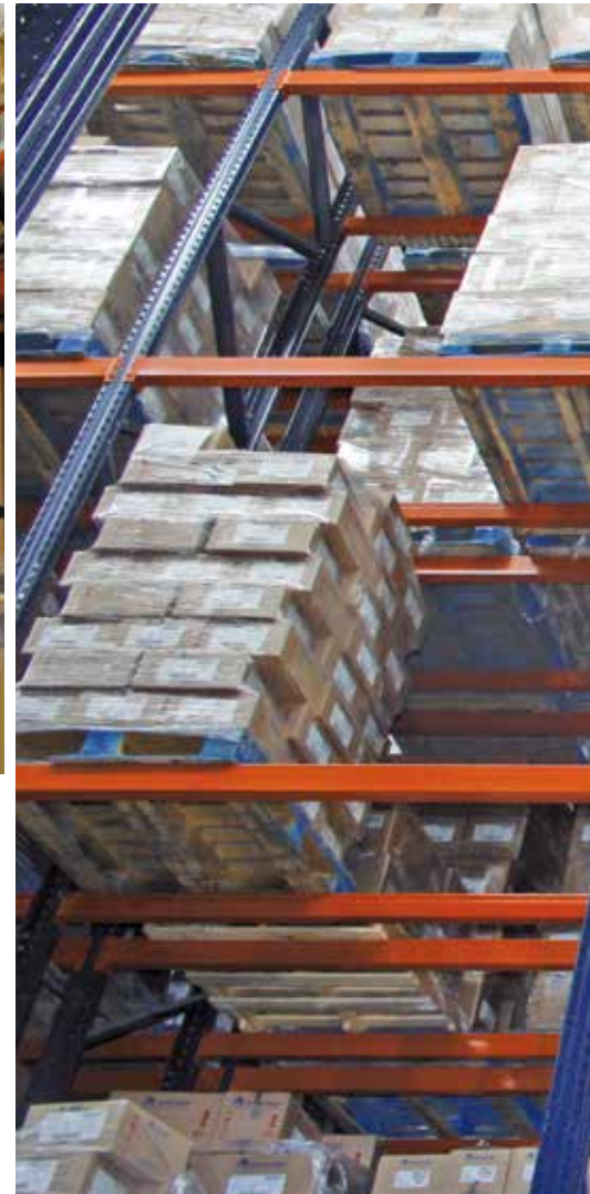
Arriba, almacén de paletización de 4 niveles de carga. Tarima manipulada por el lado de 1219.2 mm.
