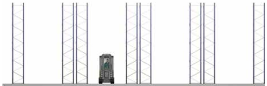
Sistema convencional más común formado por un rack sencillo adosado a la pared y racks dobles centrales.
