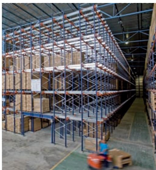
Es un sistema de almacenaje para tarimas de alta densidad que facilita la carga y descarga de mercancía a partir de un carro eléctrico denominado Radio-Shuttle.
