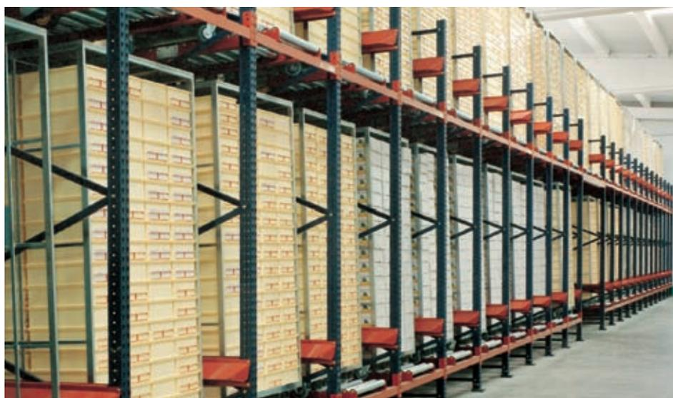
Los racks para paletización dinámica por gravedad incorporan caminos de rodillos con una ligera pendiente, lo que permite el deslizamiento de las tarimas.
