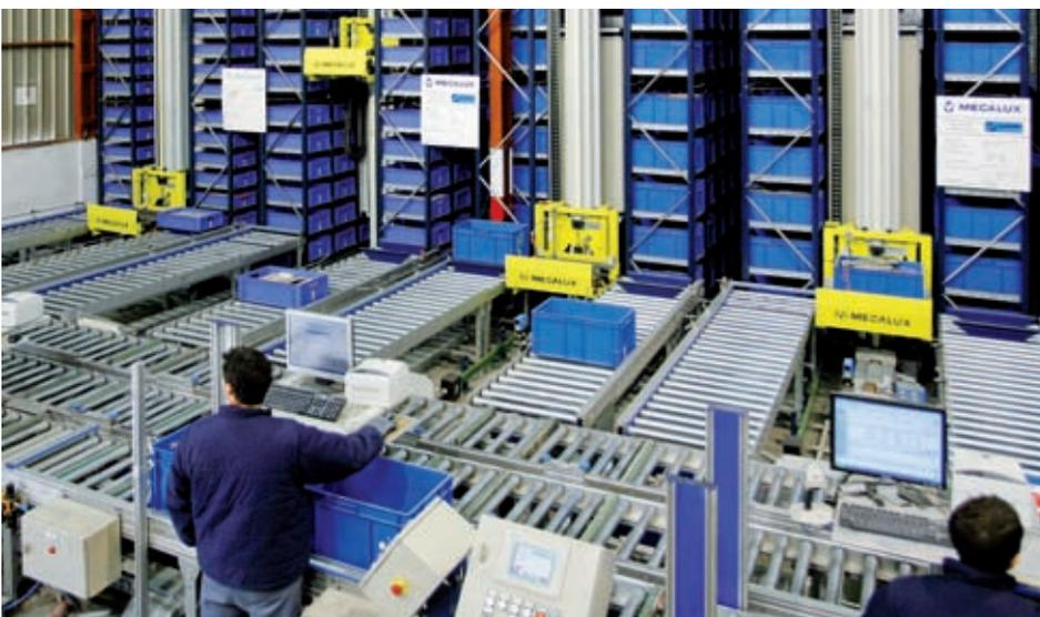
Los almacenes miniload se basan en el principio "producto a hombre": las unidades de carga (cajas), situadas en los racks, son manipuladas automáticamente por un transelevador, que las acerca al puesto del operario para que éste extraiga o deposite el producto. A continuación, las cajas son devueltas a su lugar en el rack por el mismo procedimiento.
