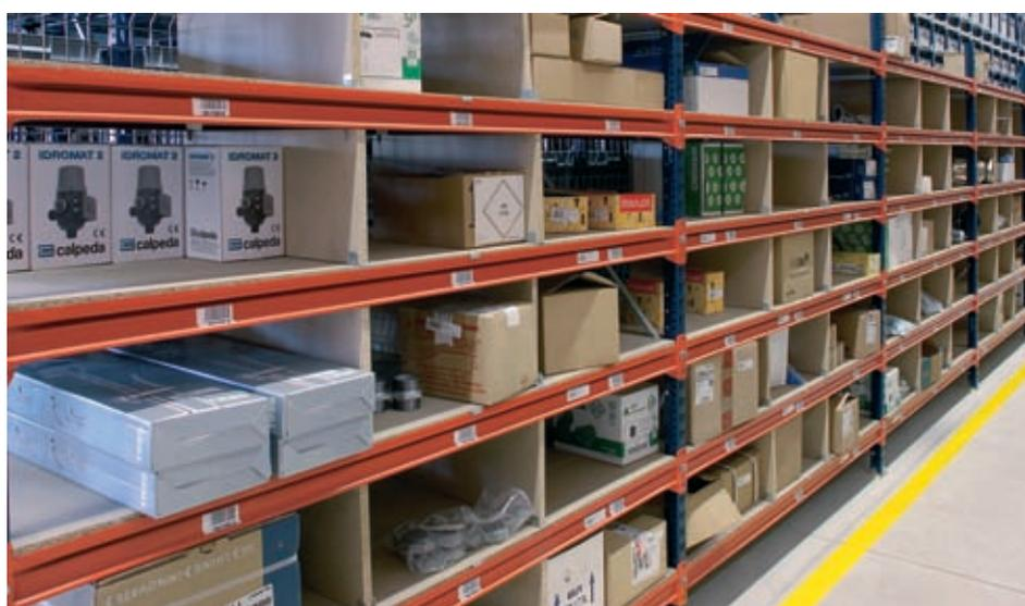
Diseñados para aquellos almacenes donde la mercancía se deposita y retira manualmente. Este sistema aprovecha toda la altura del almacén, ya que se puede acceder a los niveles altos tanto por medios mecánicos, que elevan al operario hasta la altura deseada (transelevadores o montacargas recoge-pedidos), como mediante pasarelas colocadas entre los racks.
