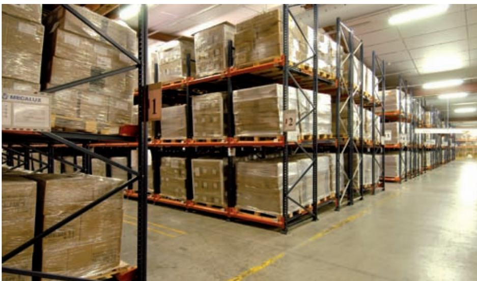
Sistema de almacenaje por acumulación que permite almacenar hasta cuatro tarimas en profundidad por cada nivel. Todas las tarimas de un mismo nivel, a excepción de la última, se asientan sobre un conjunto de carros que se desplazan, por empuje, sobre los carriles de rodadura. Las tarimas depositadas se gestionan por el principio LIFO (la última que entra es la primera que sale).
