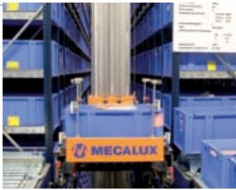
**Transelevador.** Es el robot encargado de realizar las operaciones de ubicación y de extracción de las cajas en los racks, así como de transportarlas y depositarlas en la mesa de cabecera del almacén. Tiene dos movimientos: longitudinal sobre el rail, a lo largo del pasillo, y vertical, para ubicar las cajas en los distintos niveles de los racks.
