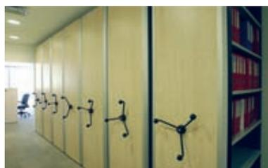
**Accionamiento manual-mecánico.** Gracias a una práctica manivela y a un conjunto de piñones y cadenas, se transmite a las ruedas motrices el movimiento en la dirección deseada. De este modo los armarios se desplazan fácilmente, con un mínimo esfuerzo.
