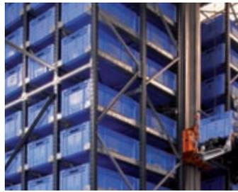
**Los racks.** Diseñados para adaptarse perfectamente al movimiento del transelevador y pensados para el almacenaje de cajas en altura. Su diseño permite un mayor aprovechamiento del espacio y un aumento de la capacidad de almacenaje, optimizando los movimientos del robot.
