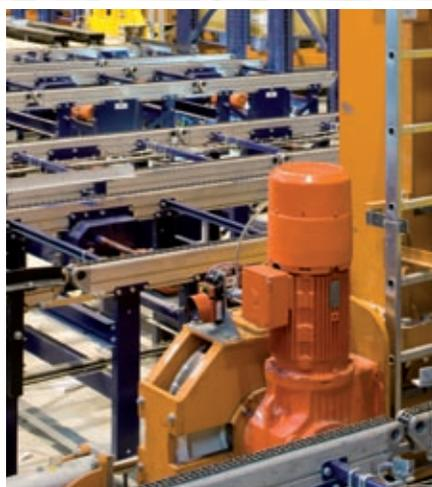
Con el objeto de asegurar un funcionamiento seguro y silencioso del transelevador, tanto la rueda motriz como la rueda libre han sido diseñadas con llanta plana mecanizada y en acero fundido. La superficie de rodadura ha sido tratada especialmente.
